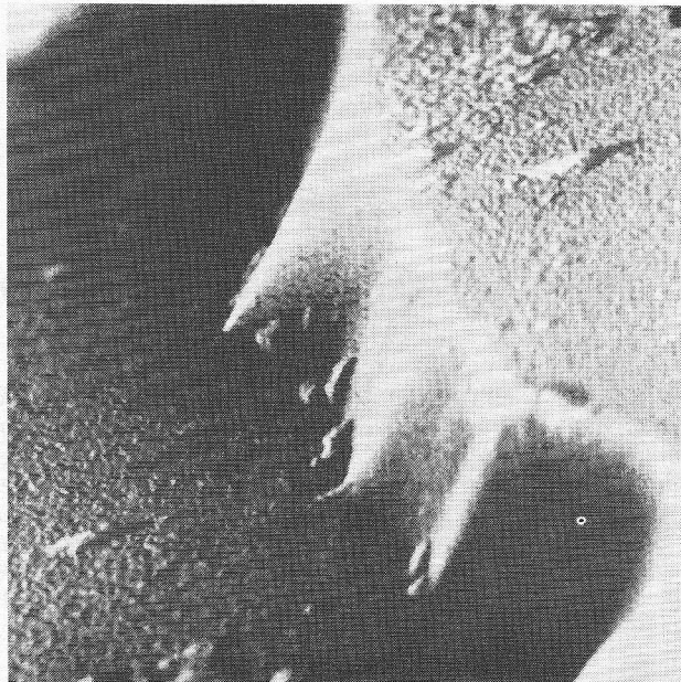
Microgram van de rand van een zeer dunne silicon dioxidelag op een silicon ondergrond, gemaakt met behulp van de door IBM ontwikkelde Scanning Electron Microscope (SEM). De laag is ongeveer 3000 Å dik. De vergroting is 200 000 maal en laat details kleiner dan 50 Å zien.
