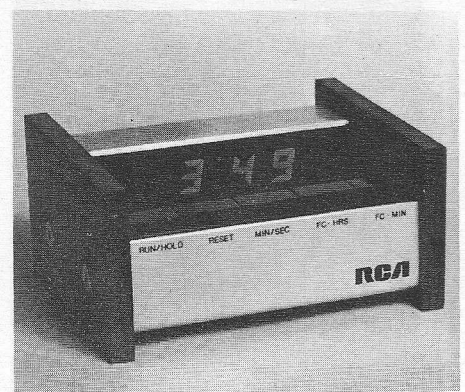
Afb. 3. Klok, opgebouwd uit CMOS compo- nenten en een vloeibare kristallen uitlezing.
